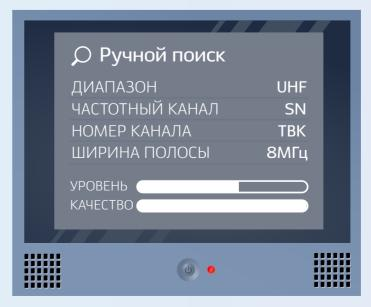
Введите: Диапазон — UHF; Частотный канал — SN; Номер телевизионного канала (TBK); Ширина полосы (или полоса пропуска) — 8 МГц
